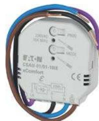
Der Schaltaktor empfängt die Schaltsignale von einem Funk-Taster und schaltet beliebige Geräte, wie z.B. Licht, Lüftung, Heizung, Alarmanlage usw., ein bzw. aus. Die Versorgung erfolgt über das Netz. Eingebaut wird das Gerät in der Schalter-, Abzweig- oder Installationsdose oder direkt in der Lampenabdeckung. Der UP Funk Schaltaktor 10 A hat eine kompakte Grösse.
