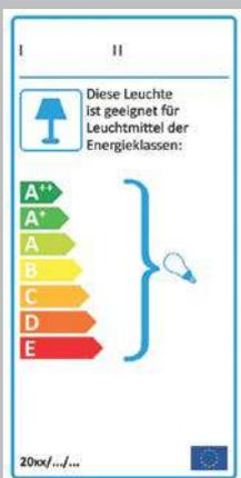
Leuchte, die mit Lampen betrieben wird, die vom Nutzer ausgetauscht werden können, und die mit Lampen aller Energieeffizienzklassen kompatibel ist, ohne dazugehörige Lampen.
