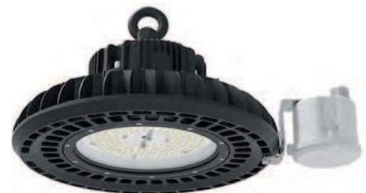
Die LEDs sind kreisförmig und symmetrisch angeordnet und verteilen so optimal das Licht im Raum. Je nach Anwendungsbereich wird mit einem aufsetzbaren Reflektor der Abstrahlwinkel von 120° auf 80° reduziert. Die Strahler sind durch das stabile Aluminiumgehäuse, das gehärtete Glas und den IP65 Standard gegen äussere Einwirkungen geschützt.
