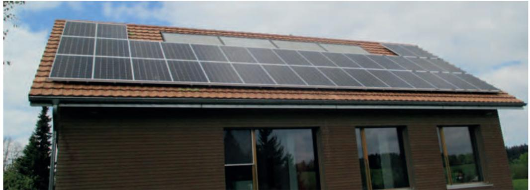
**Module:** 34 Astronergy ASM6610M 290W 4BB, **Wechselrichter:** 1 E3DC S10E12AI,
