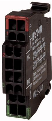
**Kontaktelement 1 Schließer1 Öffner, Frontbefestigung, Federzuganschluss**
