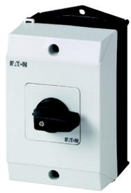
Umschalter, Kontakte: 2, 20 A, Frontschild: HAND-0-AUTO, 45 °, rastend, Aufbau
