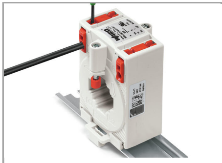
Anschließen des Leiters – Betätigung rechtwinklig zur Leitereinführung.
