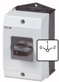
Umschalter, Kontakte: 6, 32 A, Frontschild: 0-1-2, 60 °, rastend, Aufbau
