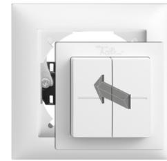
3. Schieben Sie den Apparat bis zum Einrasten der Haltefedern ein.
