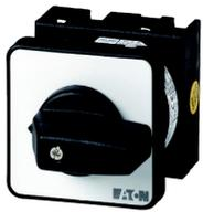
**Polumschalter, Kontakte: 8, 20 A, Dahlander-Schaltung, 2 Drehzahlen, Frontschild: 0-1-2, 60 °, rastend, Einbau**
