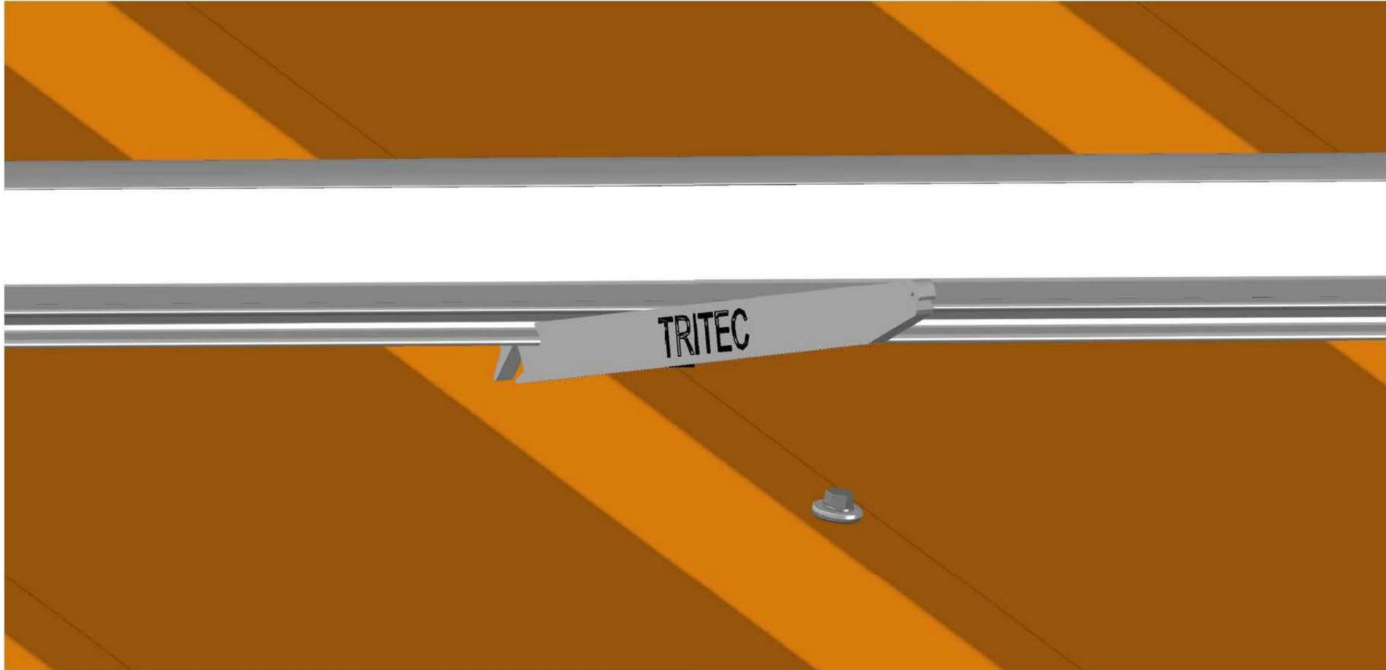
3.6 Horizontale Fixierung der TS-Profile mit dem Biegewerkzeug.
