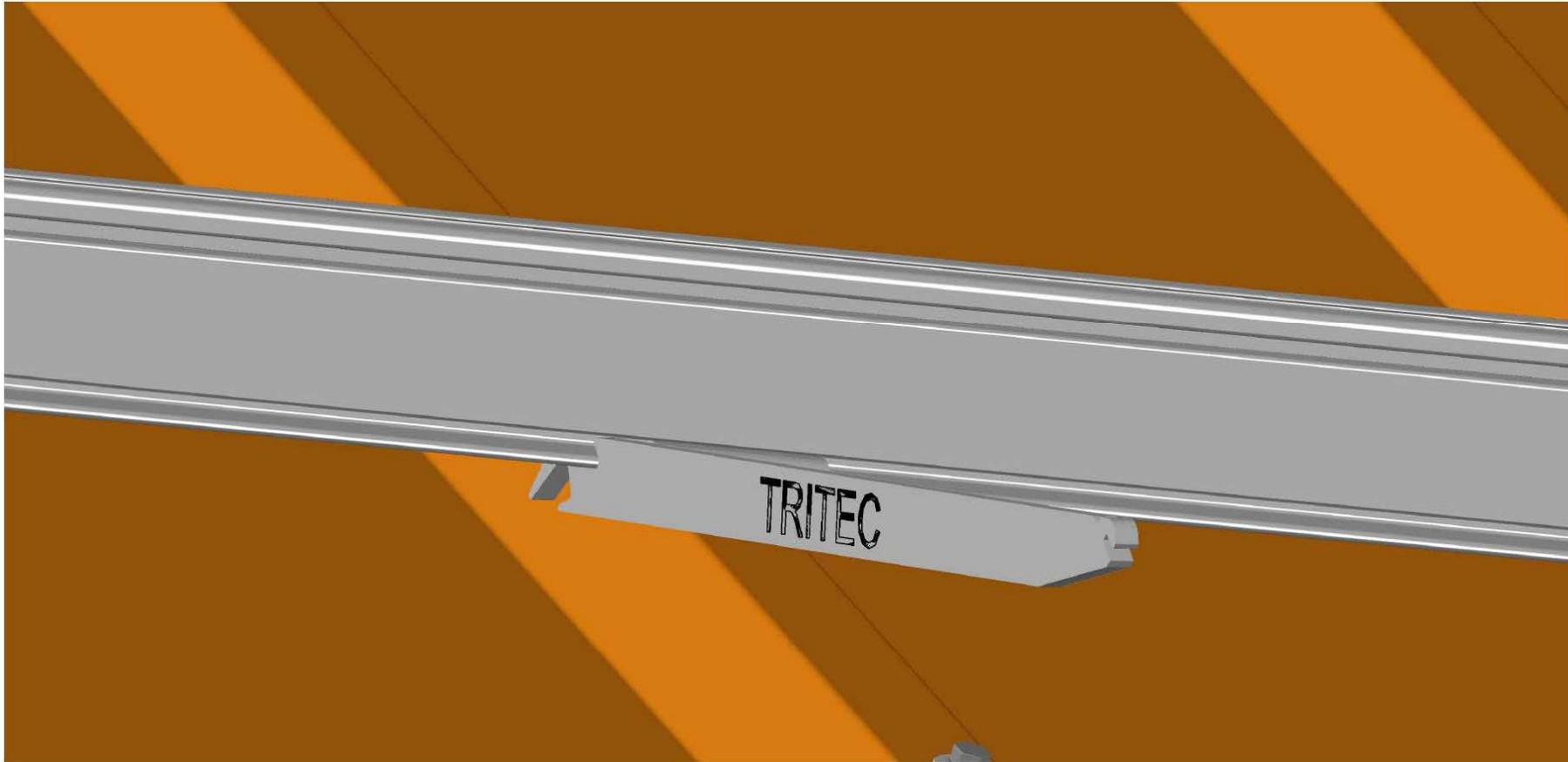
Achtung: Das UP-TS Profil darf maximal bis 12m gestoßen werden, dann folgt eine Modulfeldtrennung!
